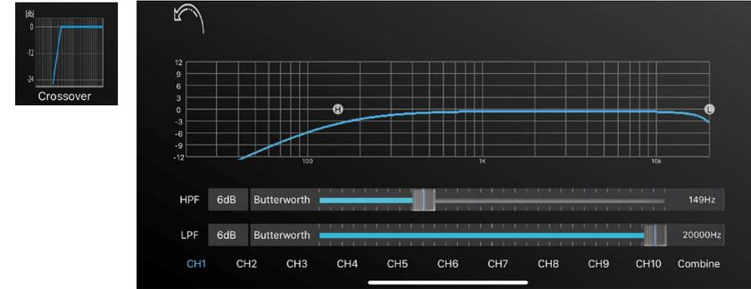
In diesem Menü können Sie den angeschlossenen Lautsprechern ein Frequenzband zuweisen, das ihrem empfohlenen Frequenzbereich entspricht. Sie können unabhängige Frequenzweicheneinstellungen für jeden Kanal einzeln oder für alle linken und rechten Kanäle zusammen wählen. Verwenden Sie einfach die Schaltfläche "Kombinieren" unten rechts und wählen Sie, ob Sie die Werte von den linken Kanälen auf den rechten oder von rechts nach links kopieren möchten.
