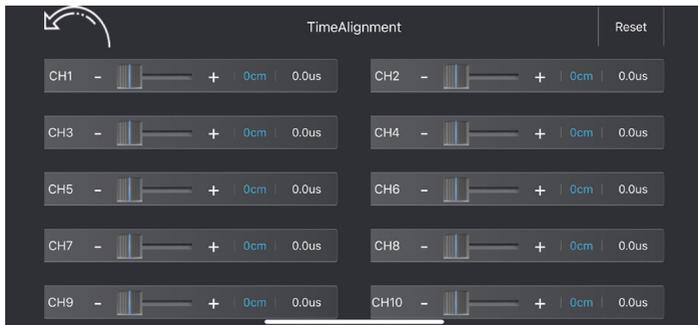
In diesem Menü können Sie eine Zeitverzögerung auf das Lautsprechersignal anwenden, um eine ideale Hörposition (ihr Ohr) zu simulieren.
