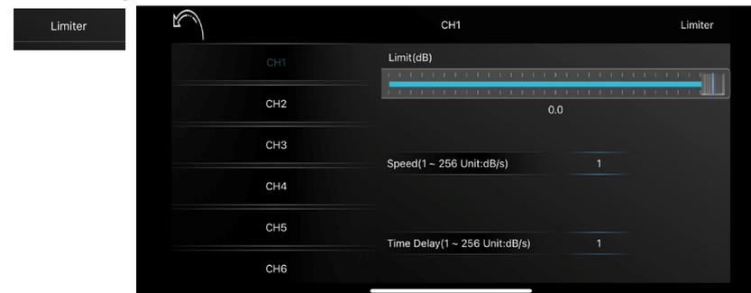
Die Limiter-Funktion ist die Rückversicherung, wenn Sie Ihre Car-Audio Anlage hart am Limit fahren. Drehen Sie die Lautstärke so weit auf, bis Sie eine Verzerrung des Tons hören, insbesondere bei den Tieftönern und Subwoofern. Wählen Sie nun den Wert (db), um wieviel der Limiter die Lautstärke reduzieren soll, wählen Sie die Geschwindigkeit (Speed), wie schnell der Limiter die Lautstärke reduzieren soll und schließlich wie lange (Time Delay) der Limiter die Lautstärke reduzieren soll.
