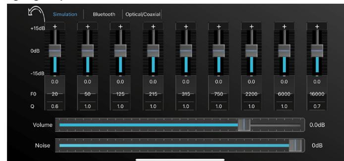
Je nach Quelle kann es notwendig sein, das Eingangssignal zu glätten, um ein genaues Tonsignal zu erhalten. Dies kann vor allem bei Fahrzeugen mit einem einfachen OE-Lautsprechersystem ohne separate Hochtöner erforderlich sein. Einige der OE-Headunits dieser Fahrzeuge sind mit einem extremen Hochtonpegel versehen, um mehr Hochton aus dem Breitbandlautsprecher zu erhalten.
